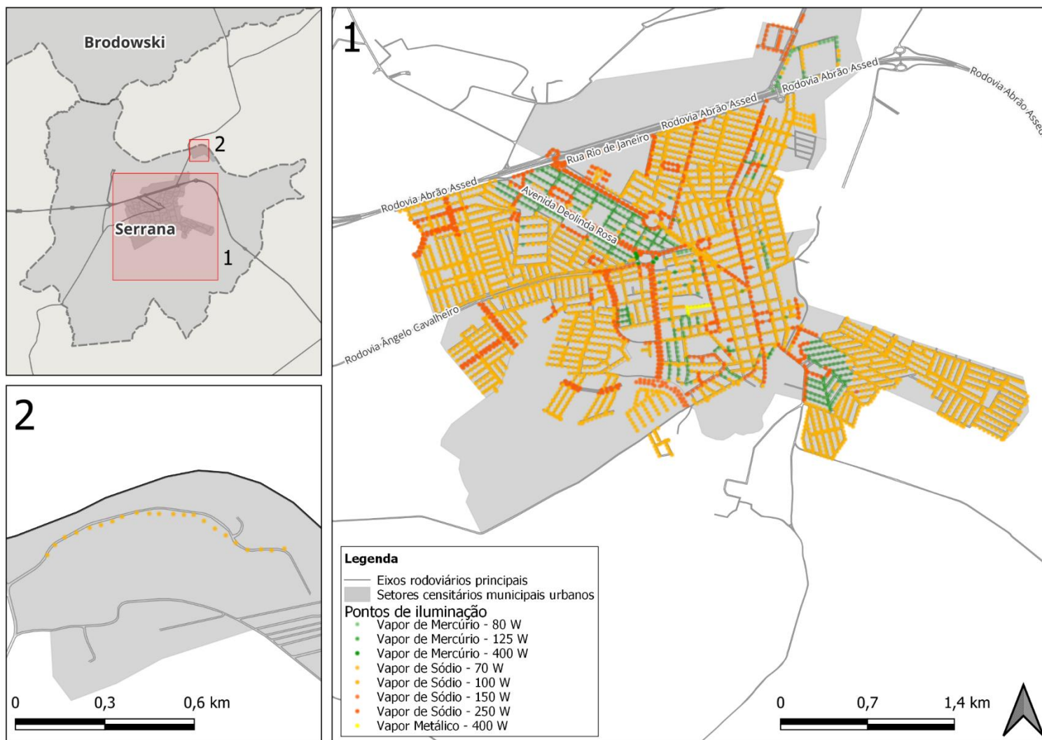
Figura 43 - Parque de I.V. de Serrana por Tecnologia e Potência
