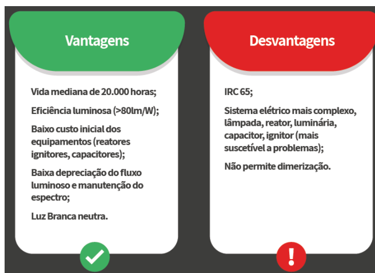
Figura 47 - Vantagens e Desvantagens - Vapor Metálico
